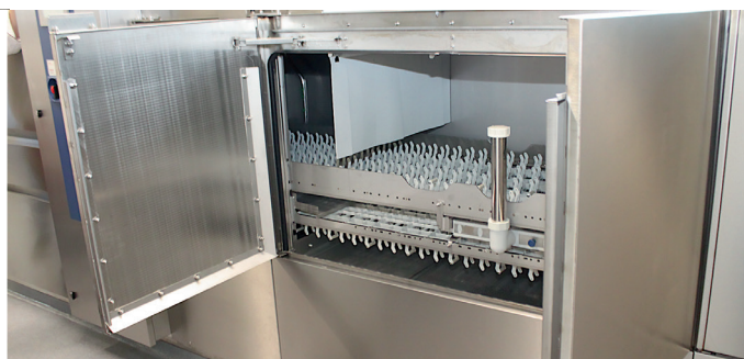
Ein Einsatz im Topfspülbecken ermöglicht ein angenehmes, ergonomisches Arbeiten (links). Fünf Flügeltüren ermöglichen es, die Bandspülmaschine unkompliziert zu reinigen (Mitte). Ausgelegt für extreme Belastungen: der Anfahrschutz bewahrt die Spülmaschine vor Beschädigungen. Fotos: CM/sah, HOBART
