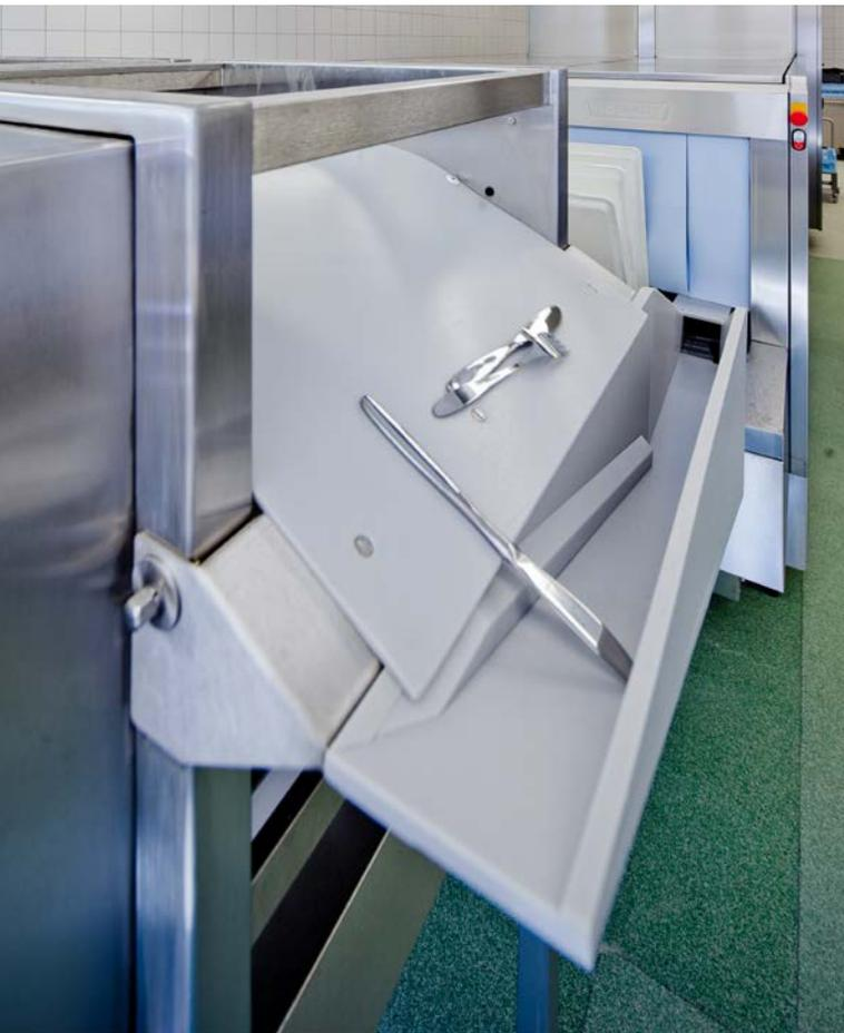
Teilautomatische Spülanlagen, bestehend aus zwei Bandspülmaschinen, zeichnen sich durch das maschinelle Handling der Tablett- und Bestecke in einer **separaten Tablett- und Besteckspülmaschine** aus.
