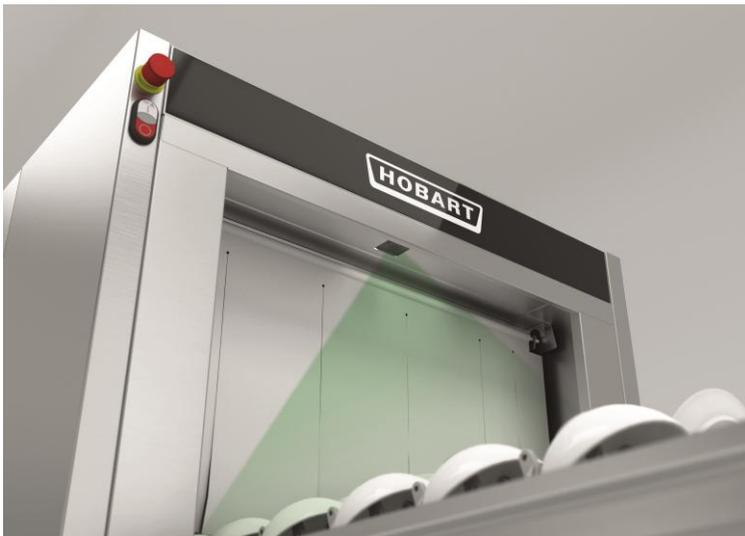
BU: Das KI-gestützte Feature SMART VISION CONTROL erkennt, welches Spülgut in die Maschine einläuft und garantiert ein optimales Spülergebnis bei geringem Wasserverbrauch.
