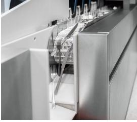
Wenn die Tabletts aus dem Restaurant zurück kommen, räumt das Spülpersonal zuerst die Gläser ab, anschließend werden Teller und Schälchen in die Bandspülmaschine gegeben und Speisereste in die Speisereste-Eingabestationen entsorgt. Tabletts und Besteck müssen nicht mehr angefasst werden, sie laufen automatisch in die zweite Bandspülmaschine und werden am Auslauf sauber abgestapelt. "Der Spülprozess ist gut durchdacht und läuft bestens. Das Spülergebnis ist sehr gut", bestätigt Busam.
