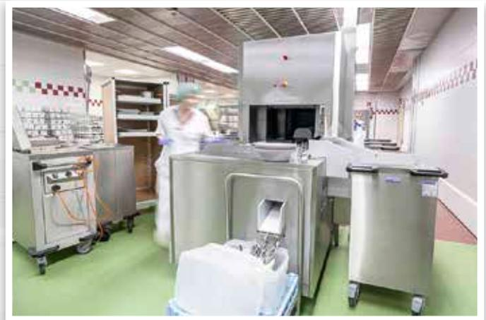
disch aus- und nach der Reinigung wieder einzubauen, ist mit dem Selbstreinigungsprogramm der AutoLine hinfällig. Es müssen lediglich die Schieber an den Armen geöffnet und das Programm angewählt werden und schon nimmt die Reinigung ihren Lauf. „Währenddessen überbrücken die Mitarbeiterinnen die Zeit, indem sie den Bereich um die Maschine reinigen“, erzählt Thomas Gansen, Betriebsleiter der Zentralküche.
