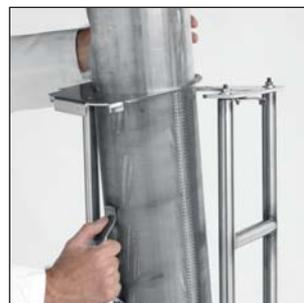
Siebzylinder und Förderschnecke sind einfach zugänglich und herausnehmbar.
