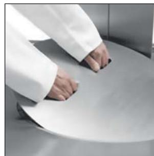
Der unbedachte Eingriff wird durch die automatische Sicherheitsverriegelung im Betrieb verhindert.
