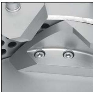
Gehärteter Chromstahl macht die Messer robust und zuverlässig. Der Verschleiß wird auf ein Minimum reduziert und die Lebensdauer damit erhöht.
