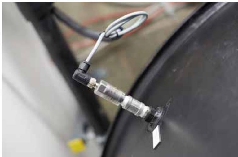
Der integrierte Sensor überwacht die Füllmenge des Tanks
